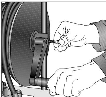
Den Hochdruckreiniger aufstellen. Dann den **Kabelbinder vom Sechskant an der Schlauchtrommel abziehen**.
