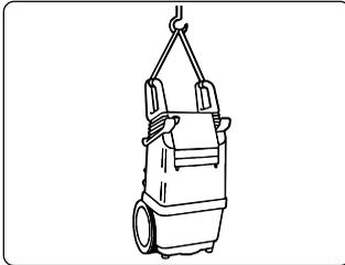
*Hebepunkte: Tragegriffe und unter der Gehäuseumlaufkante.*
