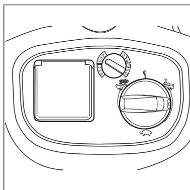
An der Saugkraftregulierung kann die Drehzahl und damit die Saugleistung variiert werden. Dies ermöglicht eine präzise Anpassung der Saugleistung an unterschiedliche Saugaufgaben.
