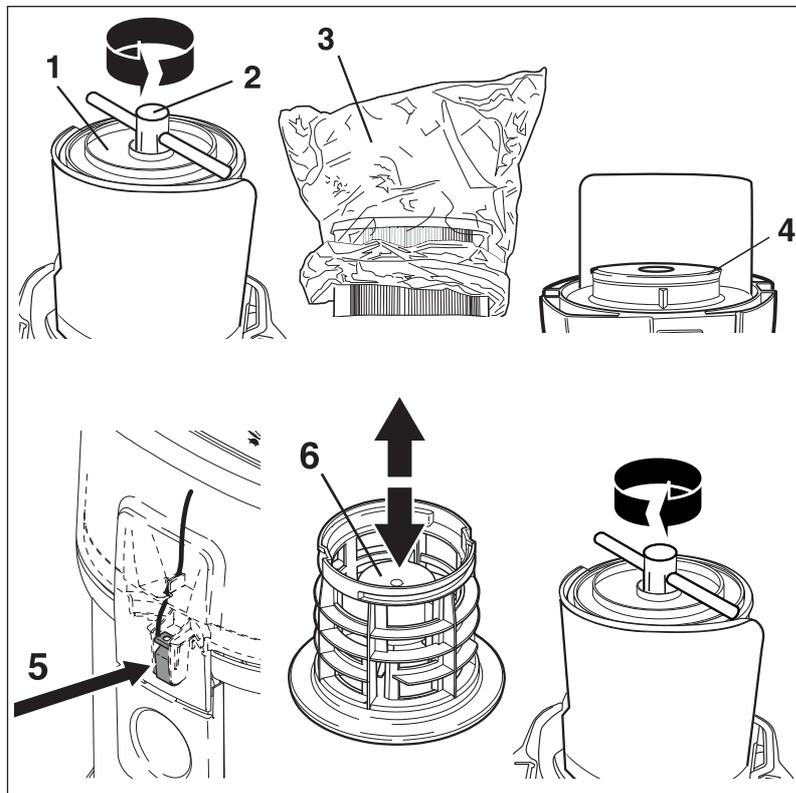
1. Filterelement abreinigen (siehe 4.5).
