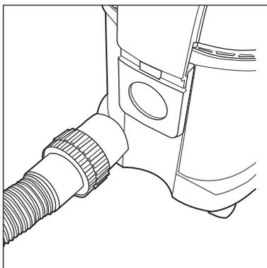
1. Saugschlauch anschließen.
