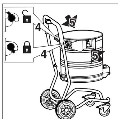
Bevor der Saugschlauch wieder eingesteckt wird: Einlassfitting und Schlauchmuffe reinigen.
