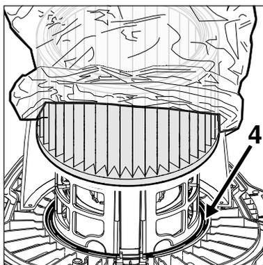
1. Saugerteil vom Schmutzbehälter abnehmen und mit dem Filterelement nach oben ablegen, dabei Saugerteil nicht auf den Abweiser (1) stellen und das Filterelement nicht beschädigen.
