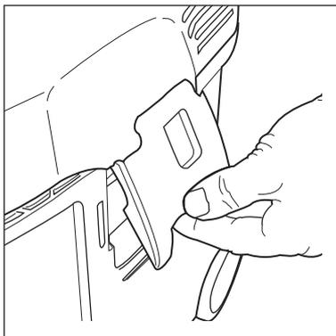
1. Verschlussklammern öffnen und Saugerteil abnehmen.
