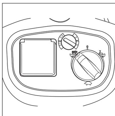
Vor dem Drehen auf Schalterstellung „auto“ darauf achten, dass das angeschlossene Elektrogerät abgeschaltet ist.
