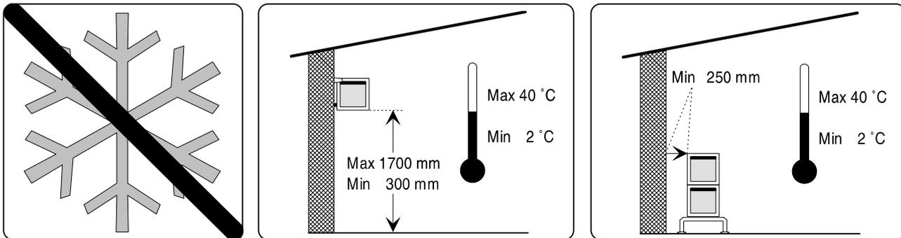
Die Anlage muß in einem frostfreien Raum aufgestellt werden. Dies gilt für sowohl Pumpe als auch Rohrleitung und Zapfstellen. Bei Zapfstellen draußen muß es möglich sein den Teil der Rohrleitung abzusperrern und zu entleeren, der frostgefährdet ist.
