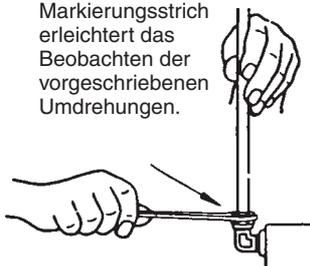
5. (**ACHTUNG: Rohr darf nicht mitdrehen!**). Hierbei erfaßt der Schneid- und Keilring das Rohr, wonach sich ein weiteres Andrücken des Rohres erübrigt. Der Endanzug erfolgt durch weiteres Anziehen der Überwurfmutter um ca. 3/4 Umdrehung. Hierbei schneidet der Ring in das Rohr ein und wirft vor seiner Schneide einen sichtbaren Bund auf.
