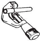
**ACHTUNG:** Keine Rohrab-schneider verwenden! Rohrwand wird schräg ge-schnitten - starke Gratbildung innen und außen.
