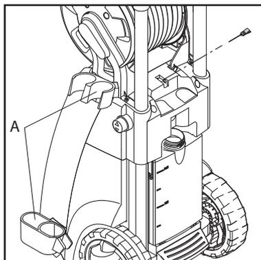
Die Standardzubehörteile (Spritzpistole, Sprührohr (A) und Düsenreinigungswerkzeug) können auf dem Hochdruckreiner gelagert werden.
