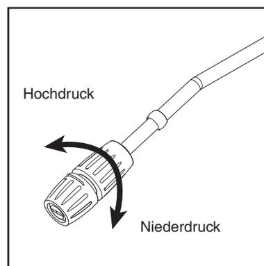
Der Druck kann auf der Flexopower Plus Düse eingestellt werden.
