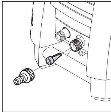
Lockern Sie den Filter sorgfältig mit einer Zange und reinigen Sie ihn. Vergewissern Sie sich, dass er intakt ist, bevor Sie ihn wieder einsetzen.
