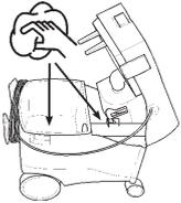
Reinigen Sie den Schmutzbehälter und Raum für die Absaugturbine vollständig (mit feuchtem Tuch abwischen).
