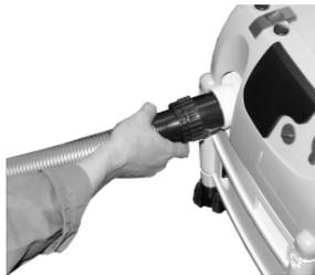
2. Saugschlauch schlingenfrei auslegen
