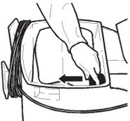
Ziehen Sie die Filtersackmuffe aus der Saugöffnung. (siehe Aufdruck auf dem Filtersack)
