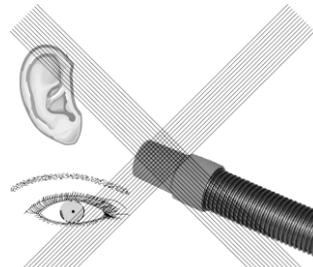
**Düsen, Saugrohre und Schlauch während des Betriebs nicht in die Nähe der Augen oder Ohren bringen !**
