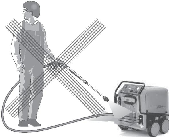
**Das Gerät nicht mit Hochdruck oder Wasserstrahl absprühen!**
