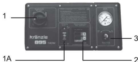
Verbinden Sie das Netzanschlußkabel mit einer vorschriftsmäßig installierten Steckdose mit Schutzleiteranschluß und FI-Fehlerstrom-Schutzschalter 30 mA. Die Steckdose ist netzseitig mit 16 A träge abzusichern.
