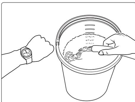
Wassermangel kommt häufiger vor als man denkt. Je leistungsstärker ein Gerät ist, umso größer ist die Gefahr, dass zu wenig Wasser zur Verfügung steht. Bei Wassermangel entsteht in der Pumpe Kavitation (Wasser-Gas-Gemisch), was in der Regel nicht oder zu spät bemerkt wird. **Die Pumpe wird zerstört.** Überprüfen Sie einfach die zur Verfügung stehende Wassermenge, indem Sie einen Eimer mit Literskala 1/2 Minute lang befüllen.
