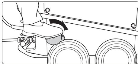
2. Vor Arbeitsbeginn Maschine mit der Feststellbremse sichern!
