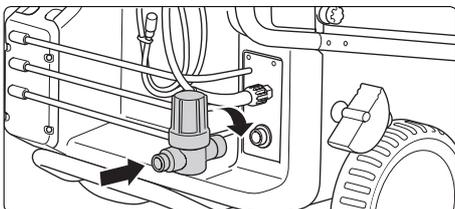
2. WassereingangsfILTER montieren.
