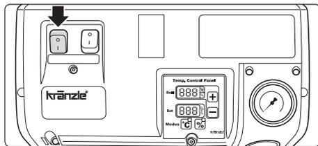
3. Hauptschalter bei geöffneter Pistole einschalten. Gerät entlüften: Pistole mehrmals öffnen und schließen. **Reinigungsmittelventil muß geschlossen sein!** (Drehknopf ganz nach rechts drehen "close")
