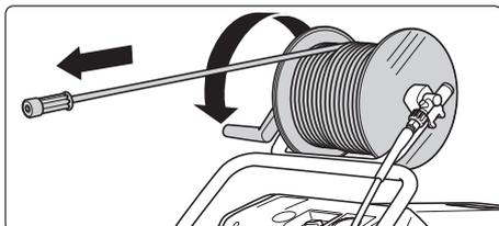
12. Hochdruckschlauch gerade und schlingenfrei von der Schlauchtrommel abrollen. Vor dem Ab- bzw. Aufrollen Pistole kurz öffnen, damit der Schlauch drucklos ist.
