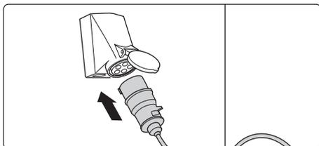
10. Stromanschluß herstellen. **Stellen Sie sicher, daß der Hauptschalter auf "AUS" steht.** Die Steckdose muß netzseitig mit 16 A träge abgesichert sein.
