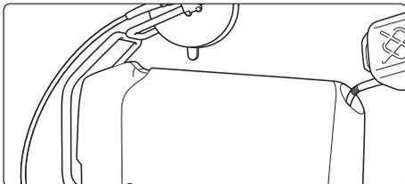
3. Brennstoff in den Brennstofftank einfüllen. (Heizöl EL DIN 51 603 oder Dieselmotortreibstoff) Max. Füllmenge 25 Liter.
