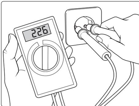
Sind in Ihrer Leitungsumgebung gleichzeitig zu viele Stromabnehmer am Netz, kann die zur Verfügung stehende Spannung deutlich sinken. In der Folge läuft der Motor des Hochdruckreinigers nicht an oder brennt gar durch. Die Stromversorgung kann auch mangelhaft sein, wenn das Stromkabel zu lang oder zu dünn ist. Zu lange Verlängerungskabel verursachen einen Spannungsabfall und dadurch Betriebsstörungen und Anlaufschwierigkeiten.
