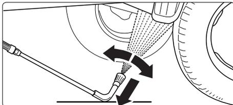
Bei der Verwendung der Unterbodenlanze die Lanze unbedingt auflegen!
