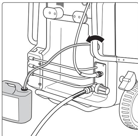
1. Zusatzmittelsieb in Behälter mit Reinigungsmittel stecken.
