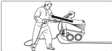
Achten Sie darauf, daß beim Reinigen mit dem Hochdruckstrahl an der Lanze ein deutlich spürbarer Rückstoß entsteht. (siehe techn. Daten S. 4)
