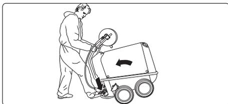
8. Maschine lenken: Zur Richtungsänderung das Gerät durch Druck gegen die Fußstütze und gleichzeitiges Ziehen am Fahrbügel ankippen und drehen.
