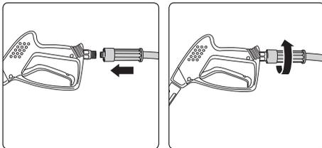
**13.** Hochdruckschlauch an die Pistole stecken.
