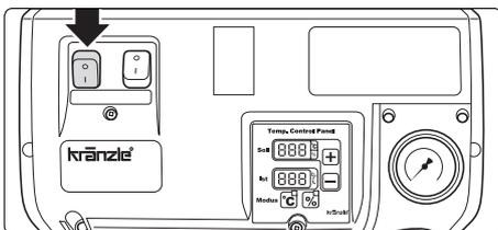
**2.** Hauptschalter bei geöffneter Pistole einschalten. Gerät entlüften: Pistole mehrmals öffnen und schließen.
