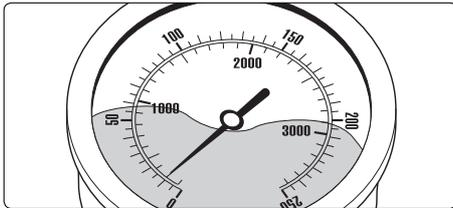
■ Das Manometer zeigt wenig Druck, aus der Düse kommt ein unregelmäßiger Strahl, der Hochdruckschlauch vibriert. Möglicherweise sind die Ventile verschmutzt.
