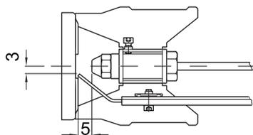
Für eine einwandfreie Zündung muß die Einstellung der Zündelektroden regelmäßig (spätestens nach je 500 Betriebsstunden) kontrolliert werden.
