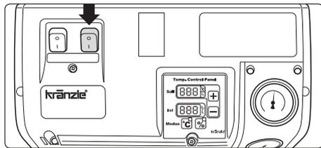
4. Zündung einschalten. Das Wasser wird erhitzt und konstant auf der eingestellten Temperatur gehalten.
