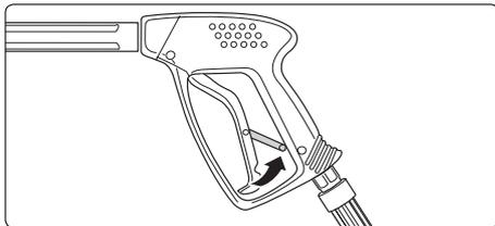
Sicherungssperre an der Pistole nach jedem Gebrauch umlegen, um unbeabsichtigtes Spritzen unmöglich zu machen!
