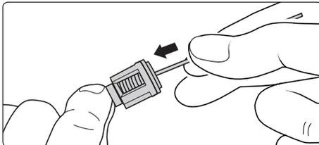
Säubern Sie die Ventile mit einem Draht (Büroklammer) und möglichst unter fließendem Wasser. Reinigen Sie auch den Ventilsitz in der Pumpe.
