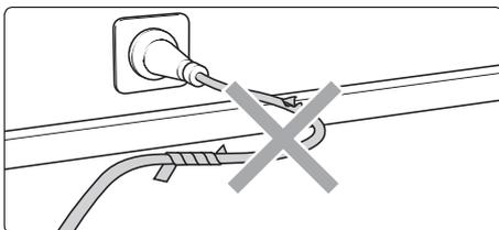
Elektrische Kabel nur in einwandfreiem Zustand verwenden! Kabel nicht beschädigen oder unsachgemäß reparieren!
