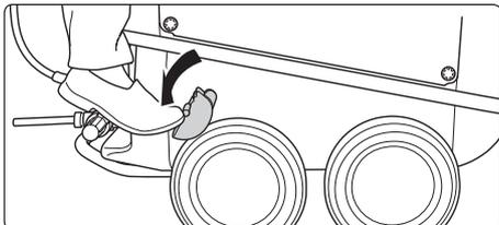
6. Feststellbremse lösen.
