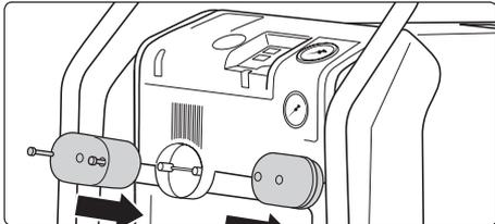
1. Elektrokabelhalterungen montieren.
