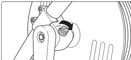
11. Fixierung der Schlauchtrommel lösen.
