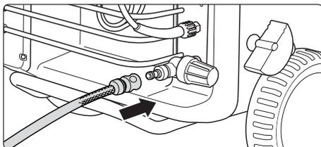
9. Wasseranschluß an Druckleitung (2 - 10 bar Vordruck) herstellen. Schlauchinnendurchmesser mindestens 1/2 ". Der Wasserkasten füllt sich. Das Schwimmerventil schliesst den Wasser-zulauf, wenn der Wasserkasten gefüllt ist.
