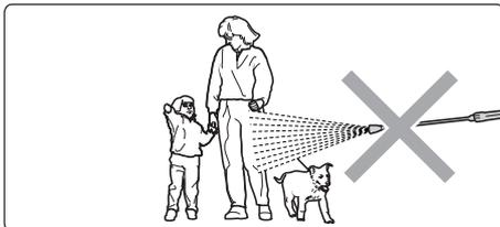
Richten Sie den Hochdruckstrahl nie auf sich selbst oder auf andere, auch nicht um Kleidung oder Schuhwerk zu reinigen.
