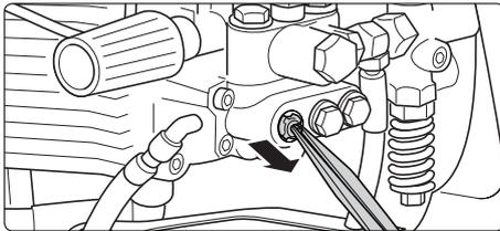
Entnehmen Sie die Ventilkörper (mit grüner oder roter Plastikummantelung) samt O-Ring mit einer spitzen Zange. Kontrollieren Sie den Dichtungsring auf Beschädigung. Bei Beschädigung muß der O-Ring ausgetauscht werden.
