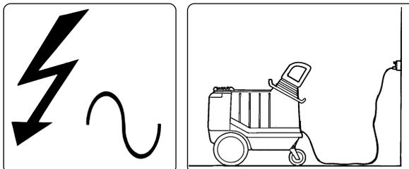
**Nur an vorschriftsmässige elektrische Installation mit Erdung anschließen.**
