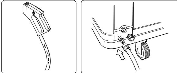
**Nur ALTO-Hochdruckdampf-schläuche mit einer aufgedruckten Temperatur von 150°C verwenden.**
