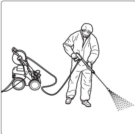
**16.** Maschine entlüften: Pistole mehrmals öffnen und schließen. Gerät bei geöffneter Spritzpistole einschalten und mit dem Waschvorgang beginnen.
