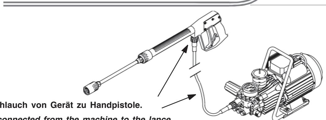
D Verbindung Hochdruckschlauch von Gerät zu Handpistole.
