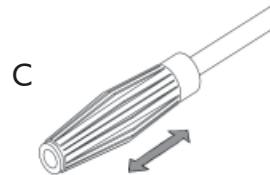
Zur Erreichung des Niederdrucks Varioregeldüse verschieben !
