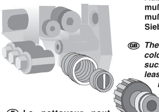
D Die Maschine kann wahlweise an eine Druckwasserleitung mit kaltem oder 60 °C heißem Wasser angeschlossen werden. Beim Außenansaugen auf sauberes Wasser achten. Schlauchquerschnitt muß mindestens 1/2" = 12,7 mm (freier Durchgang) sein. Sieb Nr.1 muß immer sauber sein.
