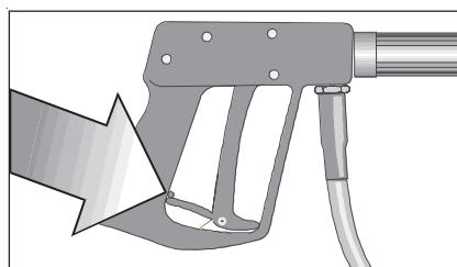
Sicherungssperre an der Pistole nach jedem Gebrauch umlegen, um unbeabsichtigtes Spritzen unmöglich zu machen!
