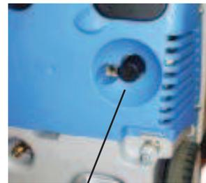
Die Hochdruckpumpe drückt nun die Luft aus den Leitungen, nach kurzer Zeit bildet sich der Hochdruckstrahl und der Arbeitsdruck wird schnell erreicht.
