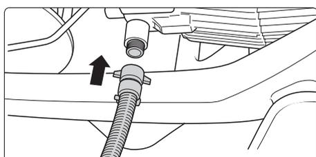
**3.** Saugschlauch mit Ansaugfilter (Kränzle-Zubehör Nr. 15.038 3) aufmontieren. Bei Verwendung anderer Schläuche muß der Schlauchinnendurchmesser mindestens  $3/4'' = 16 \text{ mm}$  aufweisen.
