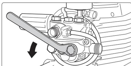
Schrauben Sie nacheinander alle 6 Ventile auf. (vertikal und horizontal in 3-er Reihe angeordnete Messigsechskantschrauben)
