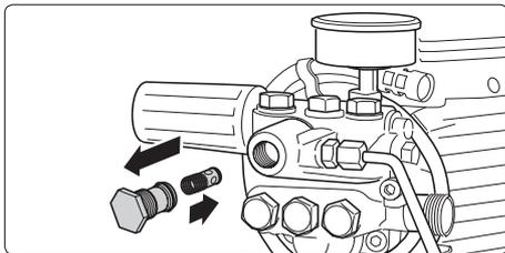
Rückschlagkörper entnehmen und auf Verschmutzung oder Beschädigung des Dichtungsringes überprüfen.
