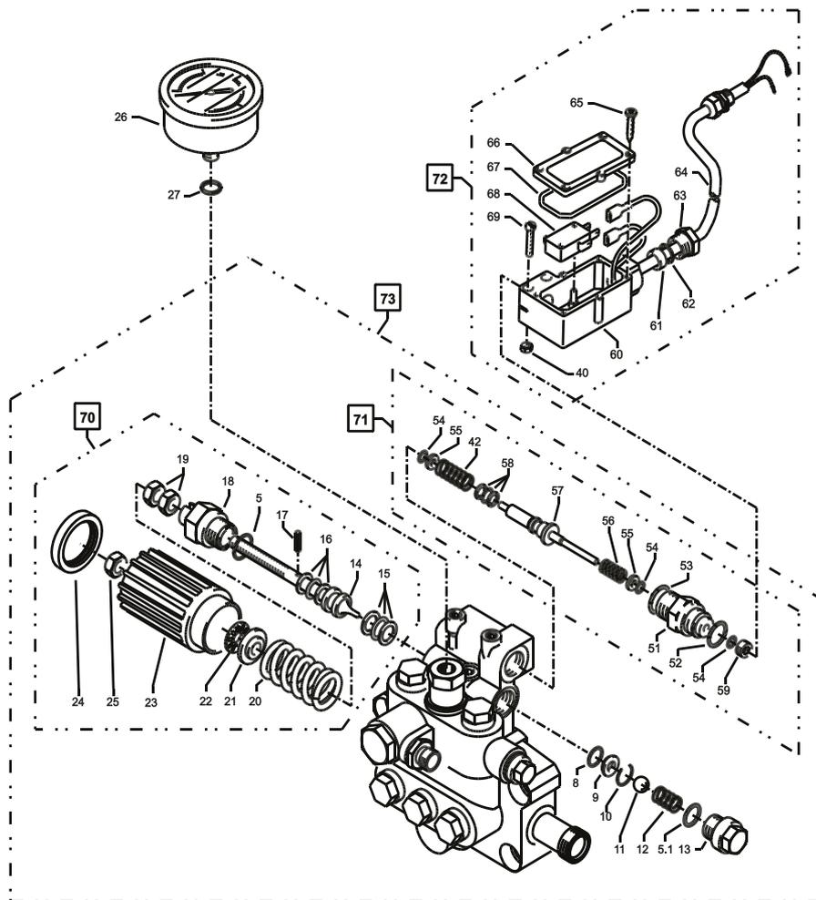
**Unloaderventil und Druckschalter**
