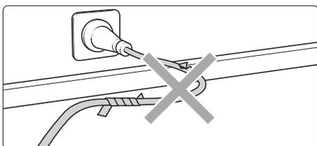
**Elektrische Kabel nur in einwandfreiem Zustand verwenden! Kabel nicht beschädigen oder unsachgemäß reparieren!**
