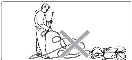
**Hochdruckschlauch nicht knicken und nicht mit Schlingen ziehen! Hochdruckschlauch nicht über scharfe Kanten ziehen!**
