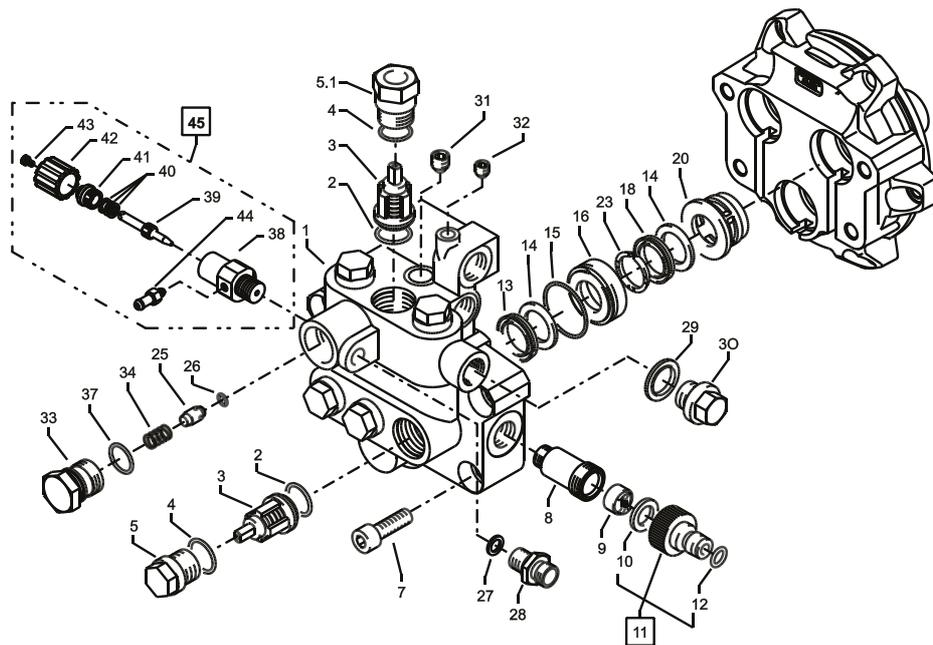
**Ventilgehäuse für AM-Pumpe integriert**
