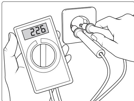
Sind in Ihrer Leitungsumgebung gleichzeitig zu viele Stromabnehmer am Netz, können die zur Verfügung stehende Spannung sowie die Stromstärke deutlich sinken. In der Folge läuft der Motor des Hochdruckreinigers nicht an oder brennt gar durch.
