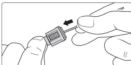
Säubern Sie die Ventile mit einem Draht (Büroklammer) und möglichst unter fließendem Wasser. Reinigen Sie auch den Ventilsitz in der Pumpe.
