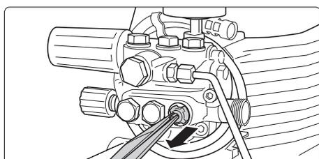
Entnehmen Sie die Ventilkörper (mit grüner oder roter Plastikummantelung) samt O-Ring mit einer spitzen Zange. Kontrollieren Sie den Dichtungsring auf Beschädigung. Bei Beschädigung muß der O-Ring ausgetauscht werden.
