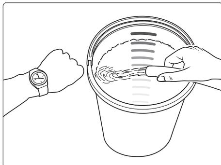
Wassermangel kommt häufiger vor als man denkt. Je leistungsstärker ein Gerät ist, umso größer ist die Gefahr, daß zu wenig Wasser zur Verfügung steht. Bei Wassermangel entsteht in der Pumpe Kavitation (Wasser-Luft-Gemisch), was in der Regel nicht oder zu spät bemerkt wird.
