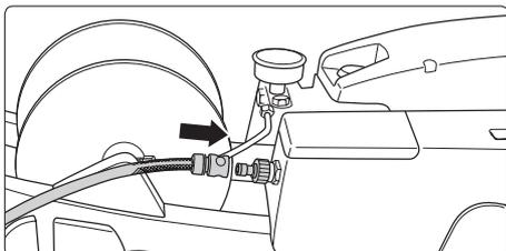
**10.** Wasserschlauch an den Wasserkasten anschließen. Das Gerät kann wahlweise an eine Druckwasserleitung mit kaltem oder bis zu 60 °C warmen Wasser angeschlossen werden.
